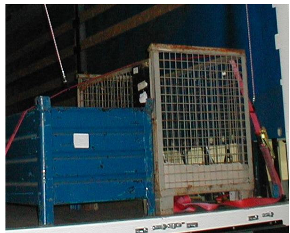
Bild 4 Beispiel einer Ladungssicherung (Typ S)
