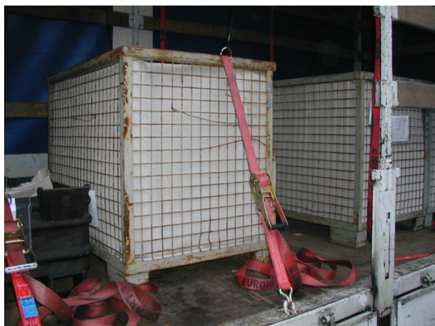
Bild 3 Beispiel einer Ladungssicherung (Typ S)
